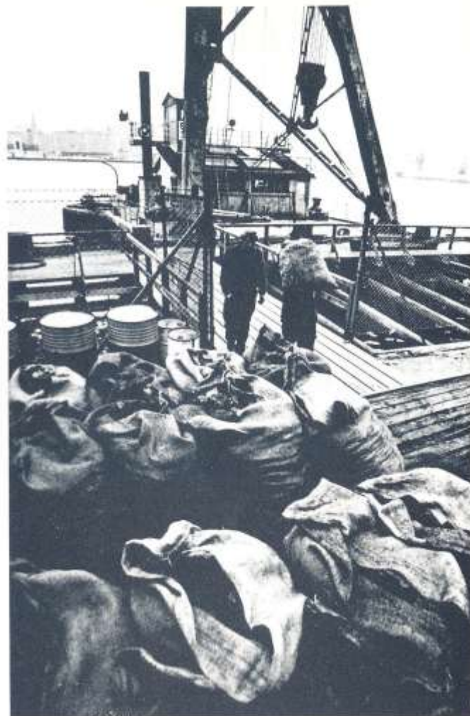
Det finns bara två ångmaskiner kvar i dagligt bruk i Göteborgs hamn; pontonkran I och Götaverkens plåtgårdskran. Pontonkranen tar in sitt kol ungefär var tredje vecka vid sitt läge i Lindholmshamnen.
